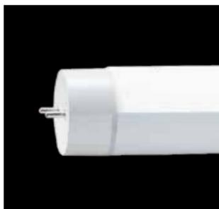
本体をポリカーボネートで包み、口金接合部には防水パッキン処理を施すことにより内部浸水を防止。既存のFLR蛍光灯と同サイズであるため市販の防水ソケットを使用可能。20日間の片側口金浸水テストをクリアしています。
